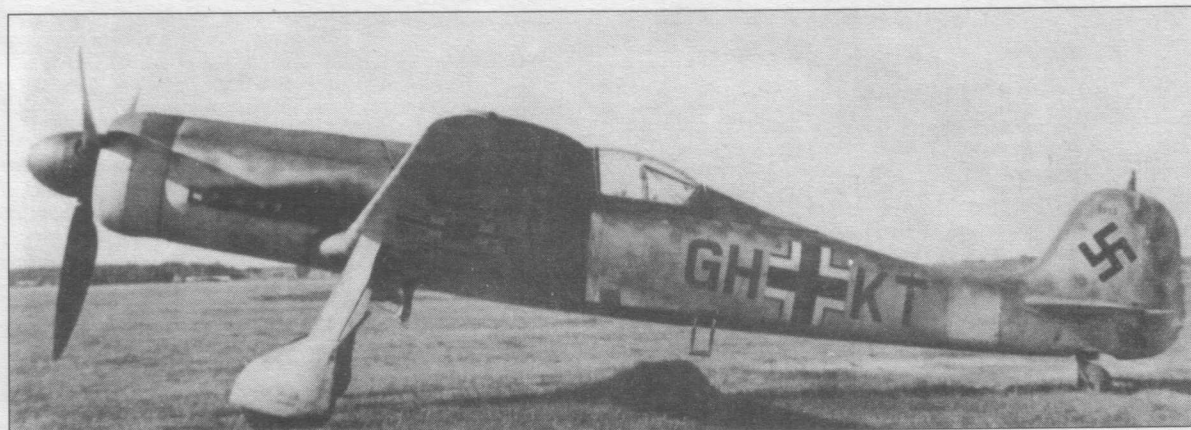
Fw 190V30/U1, W.Nr. 0055, GH+KT с двигателем Jumo 213E. Самолет был готов 6 августа 1944 года. Это первый прототип в программе Та 152.
