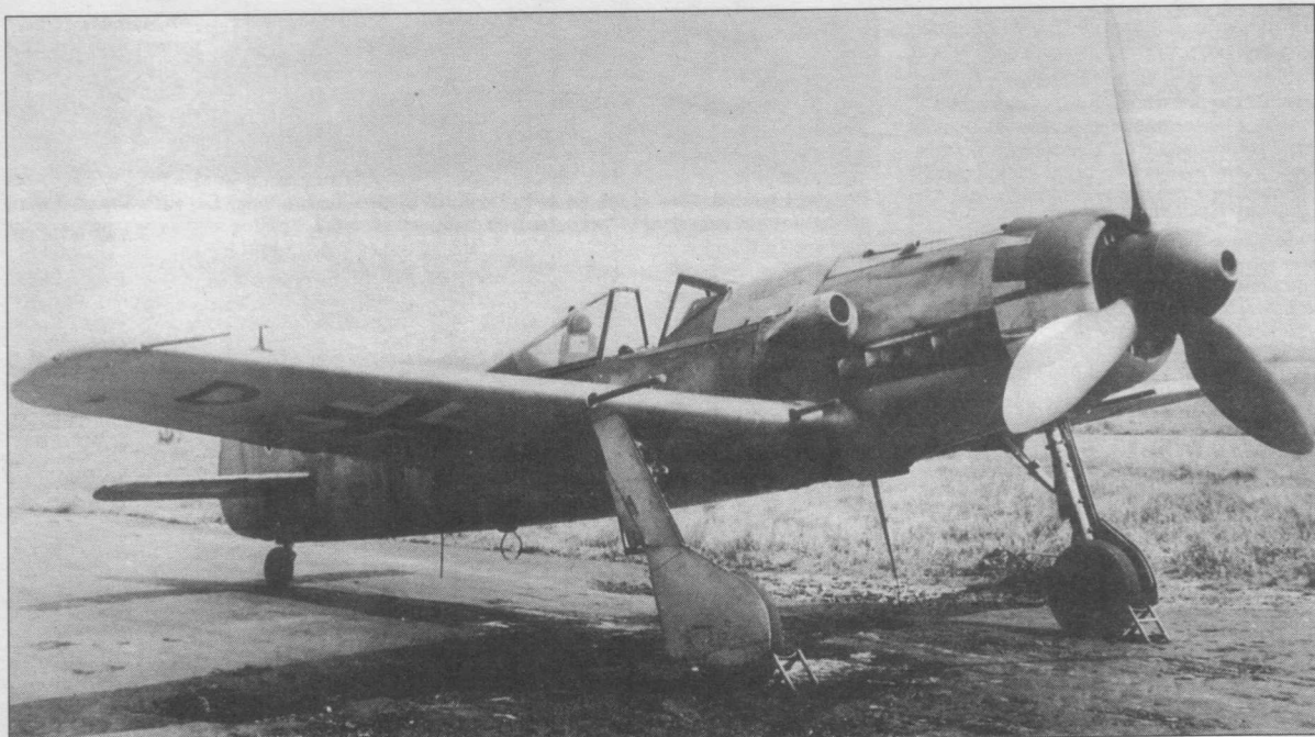
Fw 190V53 с левого борта.. Самолет представлял собой образец для серии Fw 190D-9. Виден фонарь старого типа.
