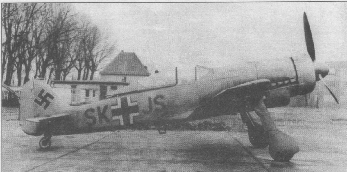
Fw 190V13, W.Nr. 0036, SK+JS, вид сбоку. Самолет был переделан из Fw 190A-0 и оснащён двигателем DB 603A.
