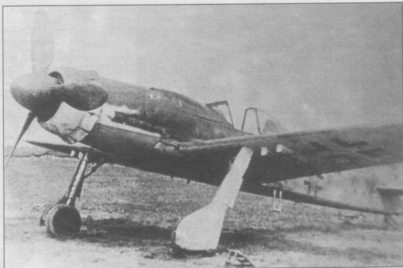
Фв 190D-9/R5 с дополнительными бомбодержателями ETC 71 под крыльями.
