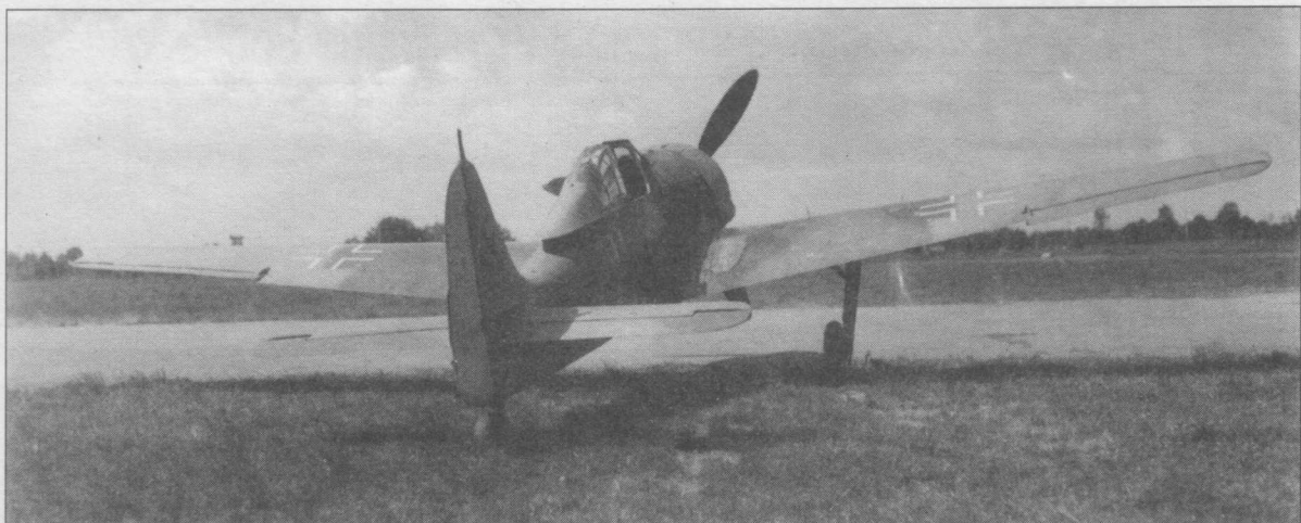
Fw 190V27, W.Nr. 0047 с двигателем BMW 801D-2 и устройством GM I. Виден фонарь гермокабины с дополнительной рамой. Обратите внимание на большой размах крыльев.
