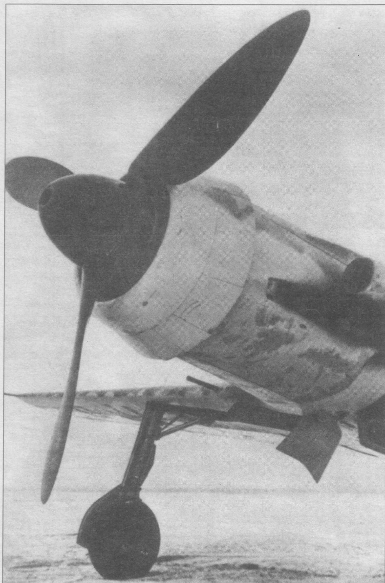
Капот Та 152V7, W.Nr. 110007, CI+XM. Виден воздухозаборник наддува на левом борту капота, характерный для двигателя DB 603.
