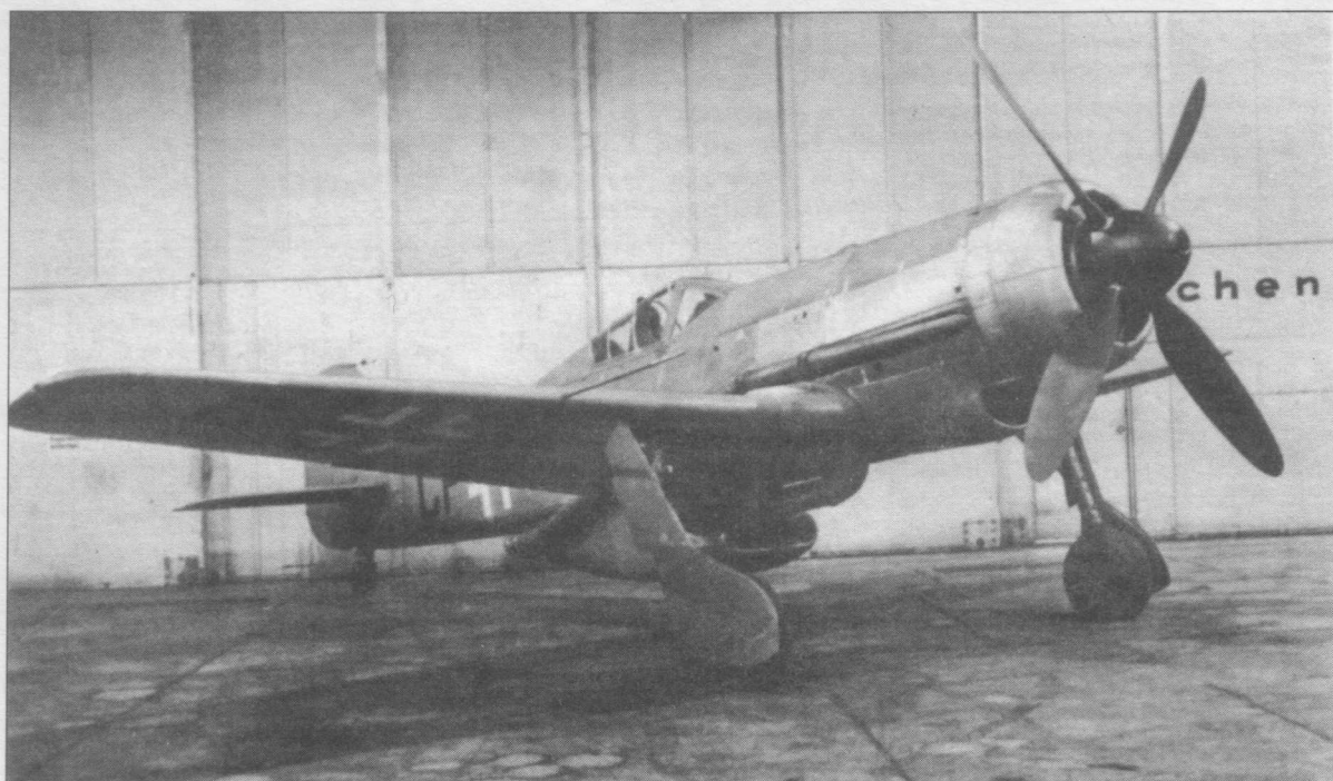
Два снимка Fw 190V18/U1 (W.Nr. 0040, CF+OY). Первый из прототипов - «кенгуру», оснащенных высотным двигателем DB 603 с четырехлопастным винтом и турбонаддувом ТК II. Данный самолет был переделан из Fw 190A-0 и отличался широким килем, гермокабиной и отсутствием вооружения в крыле.
