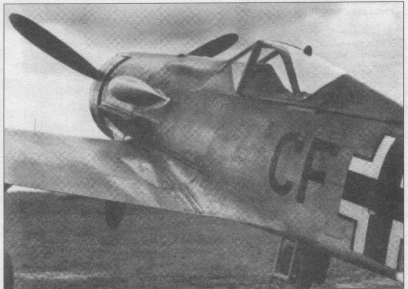
Fw 190V15, W.Nr. 0037, CF+OV, с двигателем DB 603A-2.
