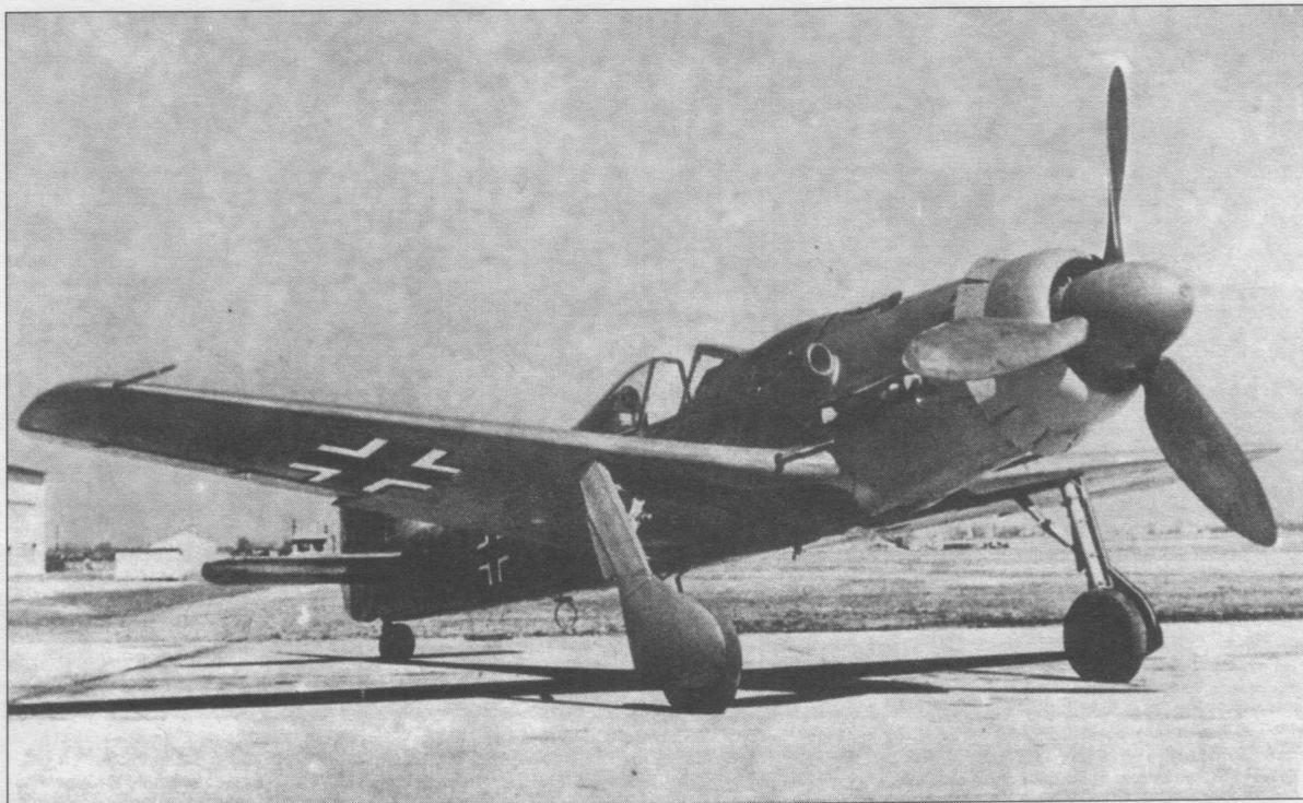
Один из первых серийных Fw 190D-9. Обратите внимание на отсутствие антенны типа «Моран» для радиостанции FuG 16ZY. Под фюзеляжем виден замок для подвески бомбодержателя.
