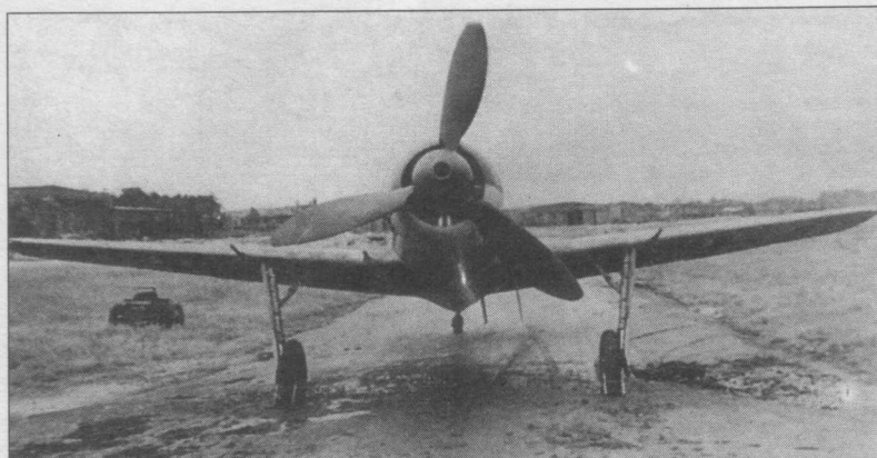
Fw 190V53, вид спереди. Хорошо видно размещение пушек в крыльях.
