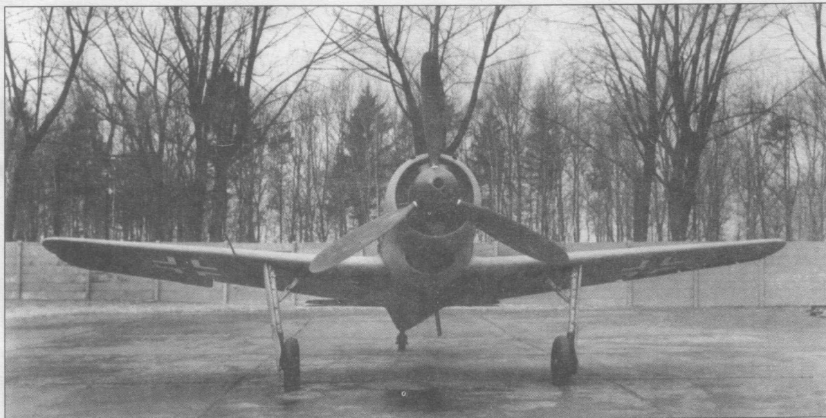
Fw 190V13, вид спереди. Обратите внимание на отверстие в коке винта и порты пулеметов MG 17 на кольце радиатора.
